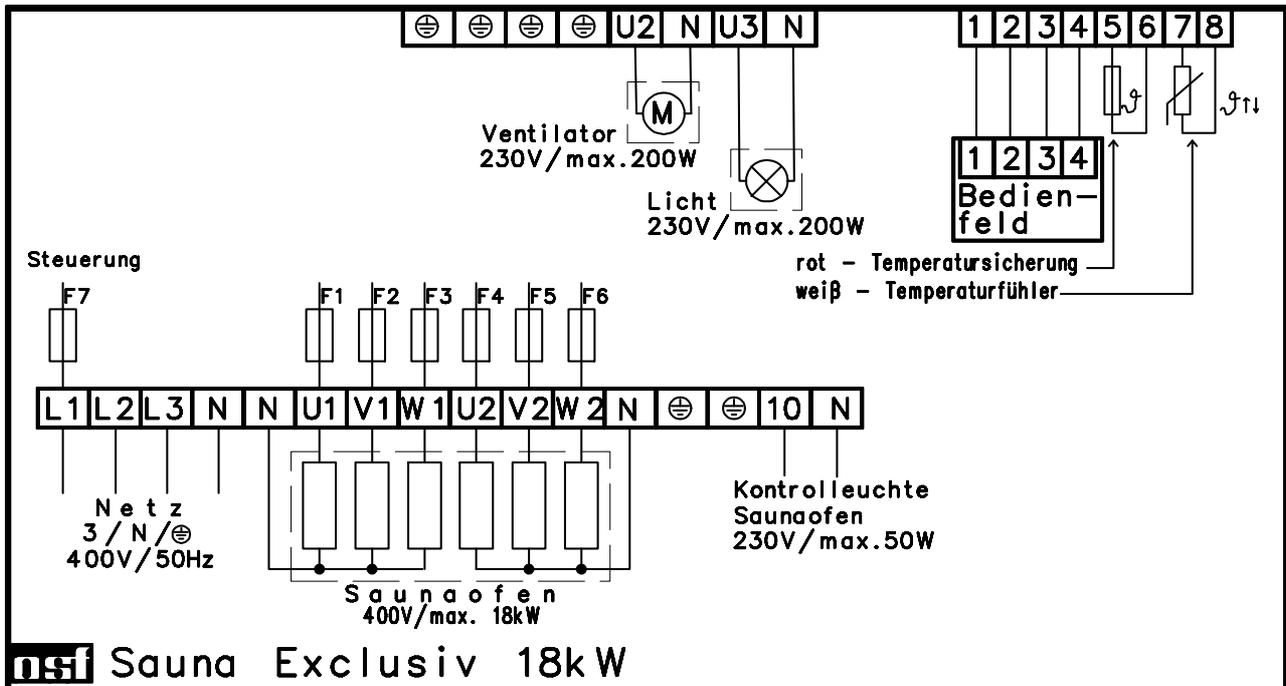
Die elektronische Steuerung ist durch eine 0,16A-Feinsicherung auf der Leiterplatte abgesichert. Die angeschlossenen einphasigen Verbraucher sind durch einen 10A-Sicherungsautomaten abgesichert. Der Saunaofen ist durch 6 16A-Sicherungsautomaten abgesichert.
